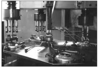
带 8 个测量点的回转阀接口用于单作用回转夹紧油缸.带 4 个测量点的多轴机械可用于铝质外壳的加工.这 4 个测量点不需要回转阀接口被塞
