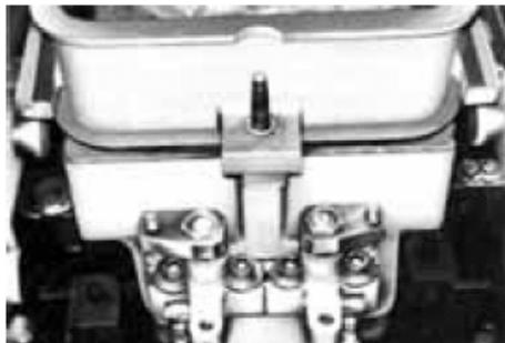
此图表示用在铸造模具体上的转位夹紧油缸。夹住模具底版。通过按钮，可在几秒钟内在夹紧与复位之间切换。
