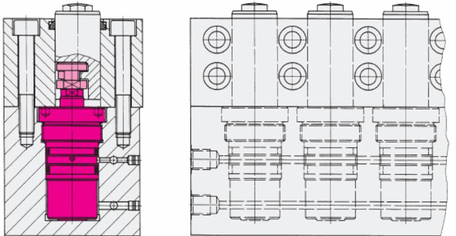
双作用外螺纹连接型油缸在多工件夹具上
